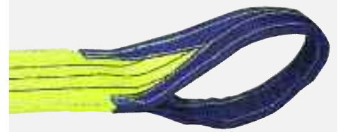
Typ B Schlaufe auf Bandebene, 2-lagig mit Vollverstärkung
