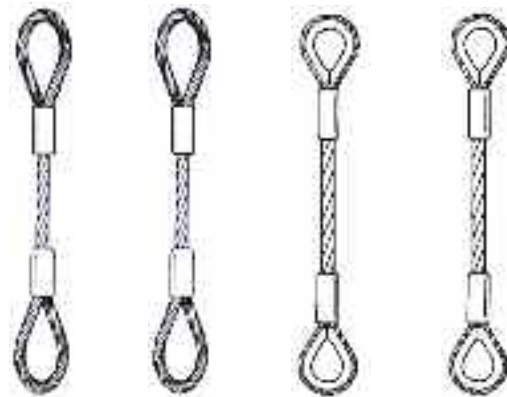
Abb. 301 Schlaufen Verpressung Kupfer Abb. 381 Schlaufen Verpressung Edelstahl Abb. 302 Kauschen Verpressung Kupfer Abb. 382 Kauschen Verpressung Edelstahl
